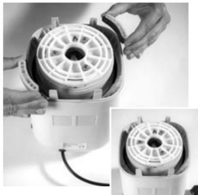
Folgen Sie den Schritten 1–3 zum Öffnen der Mockmill (S. 10/11). Entfernen Sie die beiden gegenüberliegenden Transportsicherungen zwischen Gehäuse und Mahlwerk. Fahren Sie fort mit den Schritten 5–7 (S. 11/12) zum Schließen der Mockmill.
